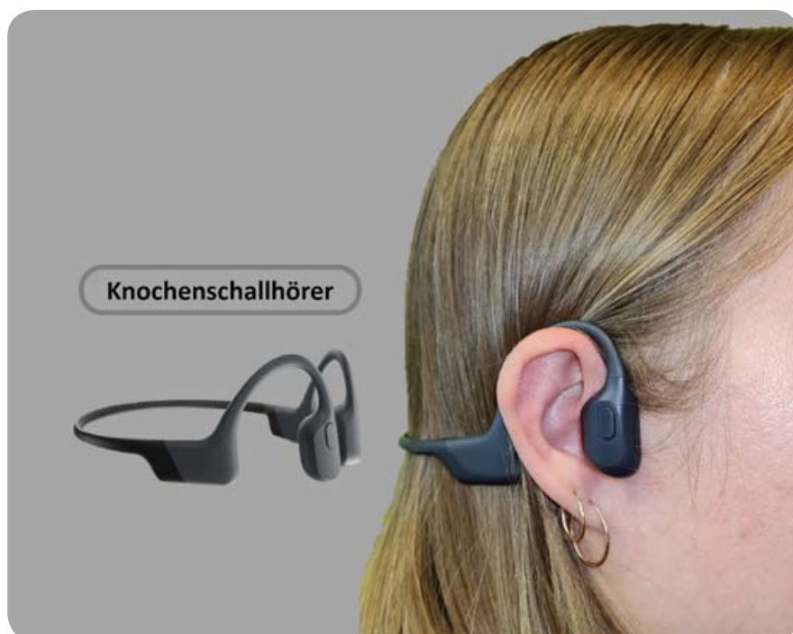
Abb. 2: Darstellung eines Knochenschallhörers und seines Sitzes am Ohr. Foto: Siegrid Meier, Krummesse.
